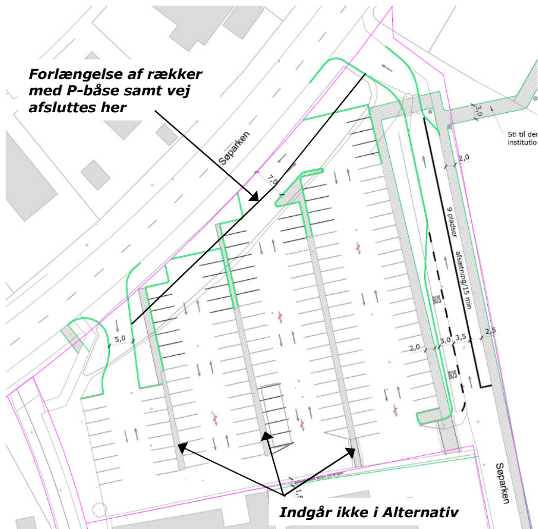
Figur 1. Illustration af alternativt forslag til forbedringer. Belægning mellem tre rækker P-båse indgår ikke i alternativet. Endvidere afsluttes P-båsene ca. 5 m længere mod sydøst.
