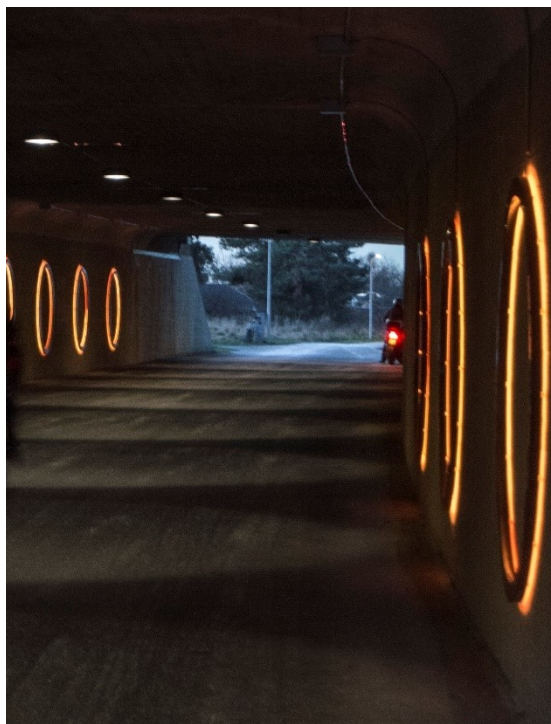
Interaktiv belysning i en tunnel på supercykelstien Farumruten.
