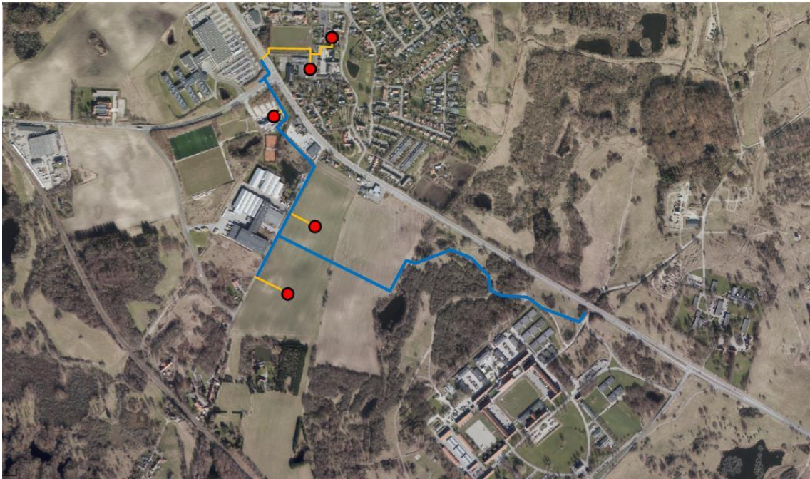
Figur 2: Blå = Forventet hoved- og forsyningsledning, Orange = Stikledninger
