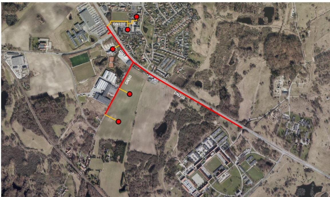
Figur 2: Rød = Hoved- og forsyningsledning, Orange = Stikledninger
