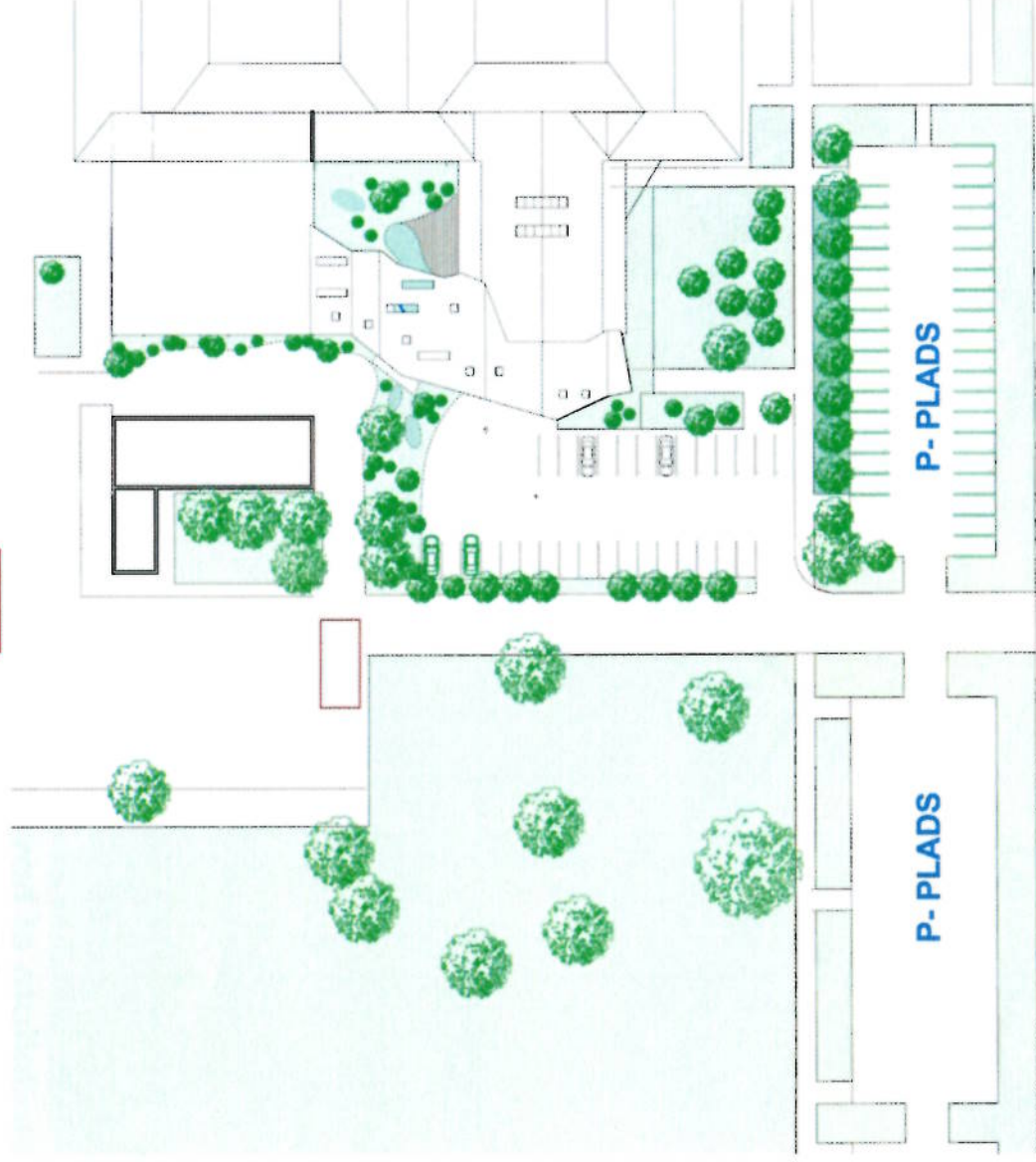
Situationsplan med nyt parkeringsareal og afsætning foran Genoptræningscenterets hovedindgang samt ny gårdhave.
